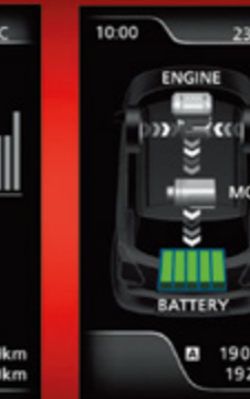
Mutatja a benzinmotor-részegítés és az energiáramlás állapotát. (Csak SHVS rendszerrel felszerelt gépkocsik esetén.)
