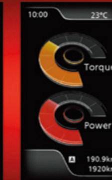
Mutatja a pillanatnyi teljesítményt és forgatónyomatékat.
