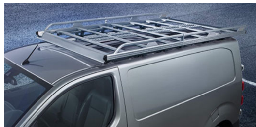
Alumínium tetőcsomagtartó L1 járműhosszhoz, 140kg teherbírás
