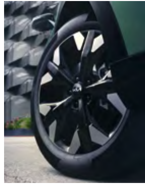
19"-os könnyűfém kerék, B típus. Kétszínű, 7,5Jx19 méretben, 235/50 R19-os abroncsokhoz. 52910CJ360PAC (Csak a PHEV modellhez.)
