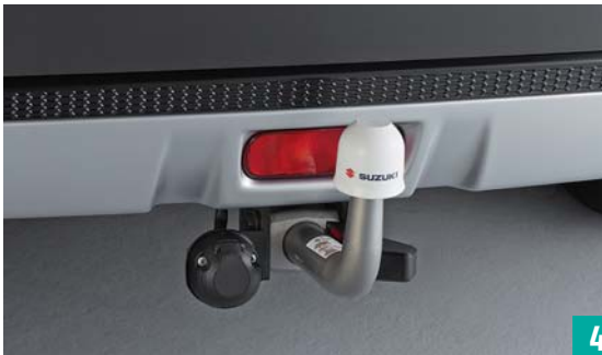
4 | Vonóhorog, levehető fej 11 utánfutókhoz és egyéb szállító- rendszerekhez. Kérjük, külön rendelje meg a vonóhoroghoz szükséges elektromos készletet. Maximális vertikális terhelhetőség: 75 kg. Cikkszám: 72901-54P00-000
