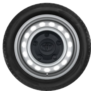
16" acél keréktárcsák 205/60 R16 méretű gumiabroncsokkal
