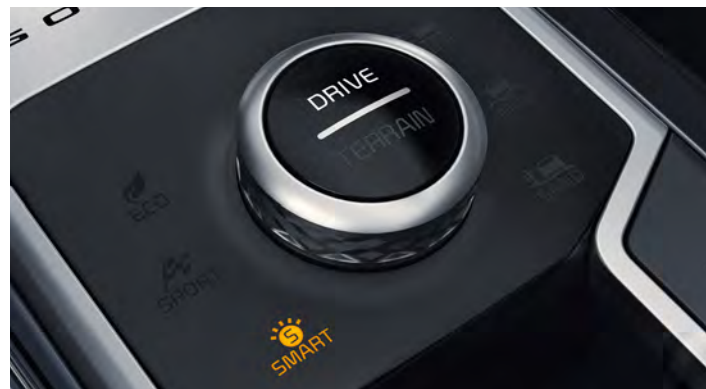
ÜZEMMÓDVÁLTÓ KAPCSOLÓ (DMS)
